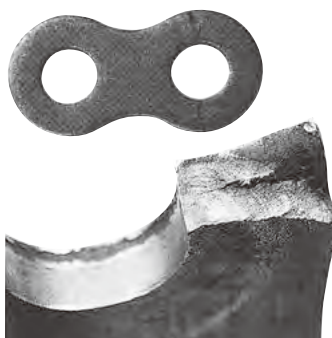
② Fatigue fracture
